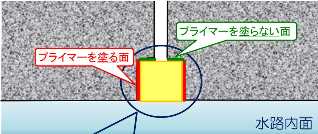
シリコン系のシーリング材などは、コンクリート面との接着力を確保するために、プライマーを塗布します。
