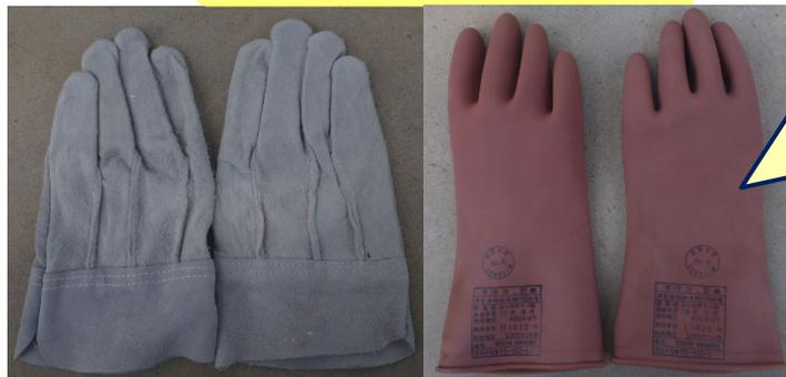
回転する機械を使用する際に軍手を使用すると巻き込まれる可能性が大きいいため、革製かゴム製の手袋を使用する。
