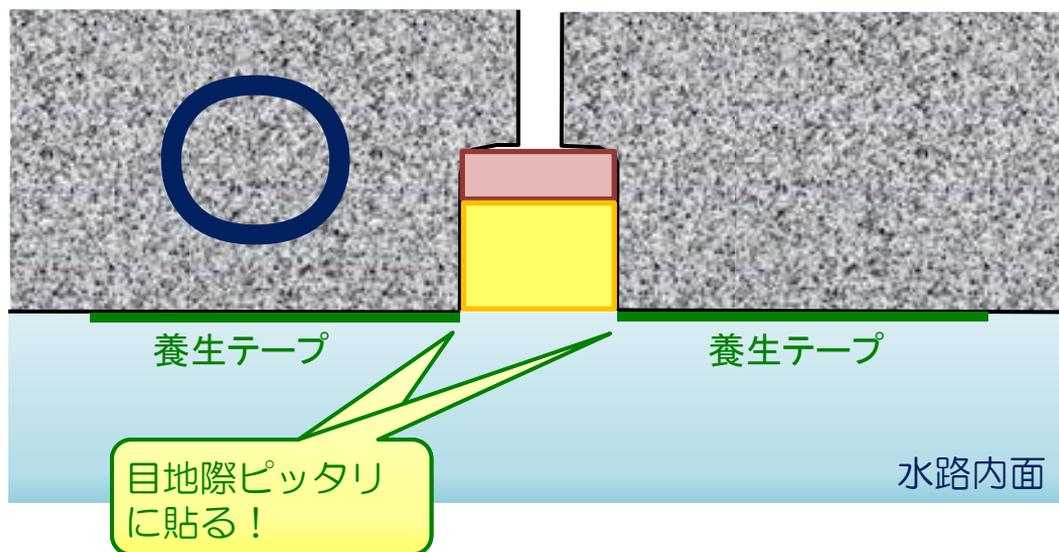
目地からはみ出たシーリング材は薄く、剥がれの原因となるため、目地際ピッタリに養生テープを貼り、目地以外の場所にシーリングしないようにします。
